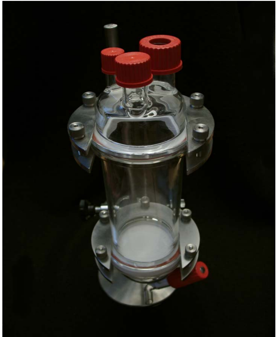
(Sonderausführung: Filtereinheit mit Glasfilter, Mittelstück und Auslaufventil)
